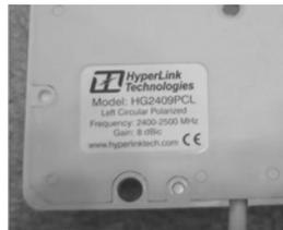
Figura 1.8 Ejemplo de etiqueta que indica las polarización de una antena
