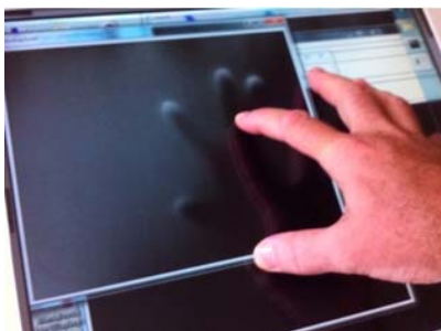
Figura 5. Detección por visión de los blobs correspondientes a cada dedo
