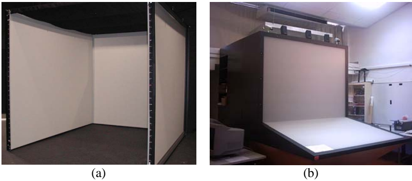
Figura 1. Dispositivos de salida de RV: cuevas o caves (a) y workbench (b)
