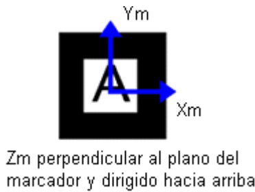
Figura 12. Sistema de coordenadas local al marcador utilizado por ARToolkit
