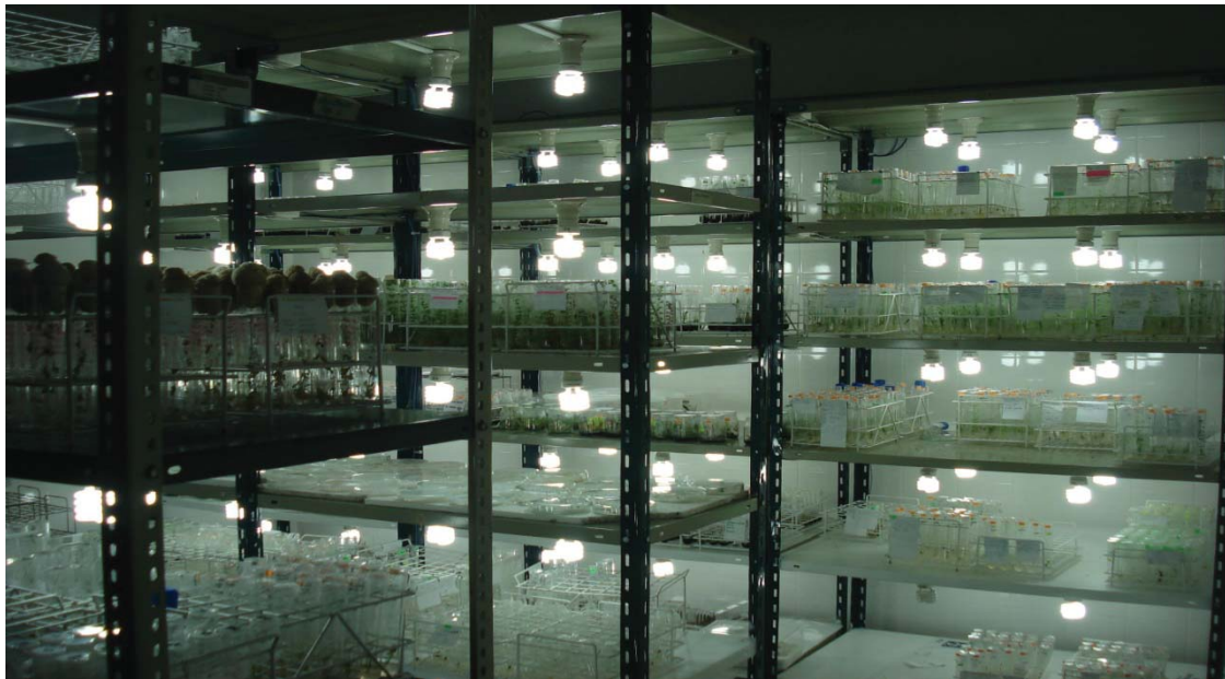
Figura 4. Cuarto de cultivo clásico. Construido con carpintería metálica estándar pintada de blanco con pintura antióxido. Cuenta con 2 o 4 lámparas larga vida según estante en particular, este posee una irradiancia de 3500 lux en la zona del explanto.
