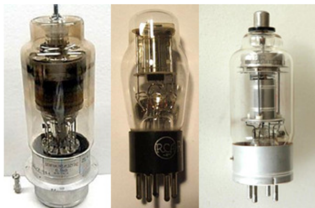
Figura 5.1: dispositivos de potencia valvulares
