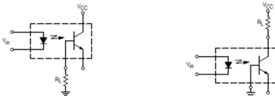
Figura 4.79: Circuitos básicos con optoacoplador con fototransistor
