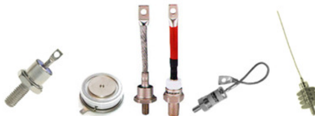
Figura 1.25: encapsulado típico en diodos de potencia
