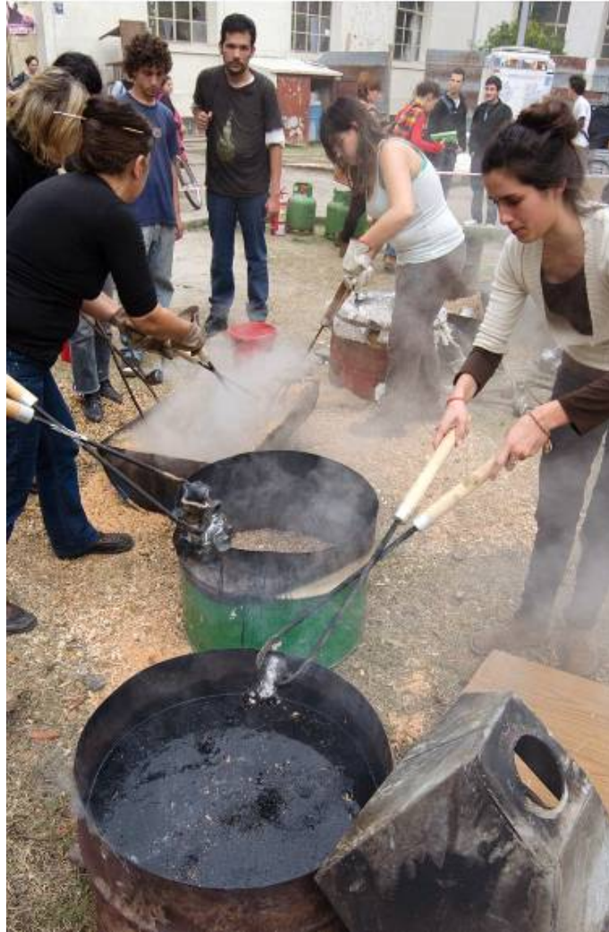
Sumergiendo las piezas en agua para detener la reducción (Foto: Guillermo Sierra).
