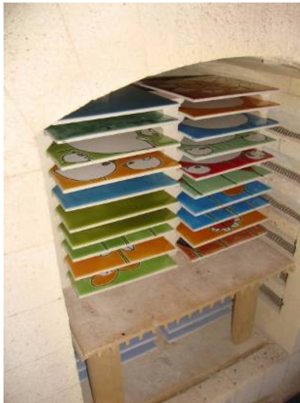
Florencia Melo. Horneada lista para descargar. El sistema de peines permite un uso óptimo del espacio
