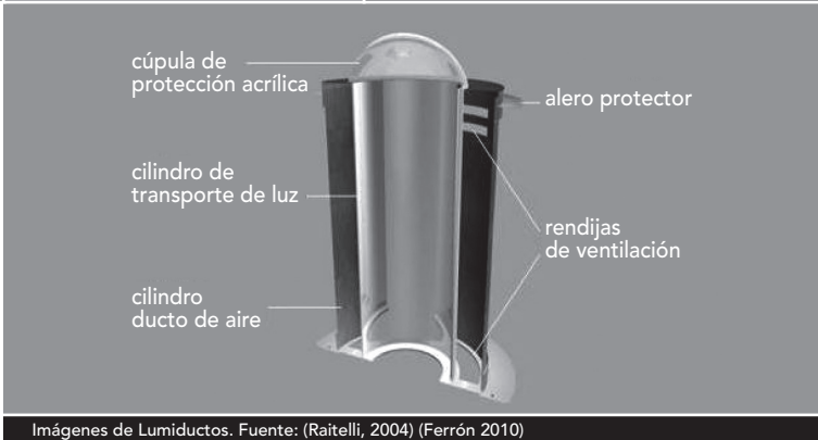
Imágenes de Lumiductos. Fuente: (Raitelli, 2004) (Ferrón 2010)
