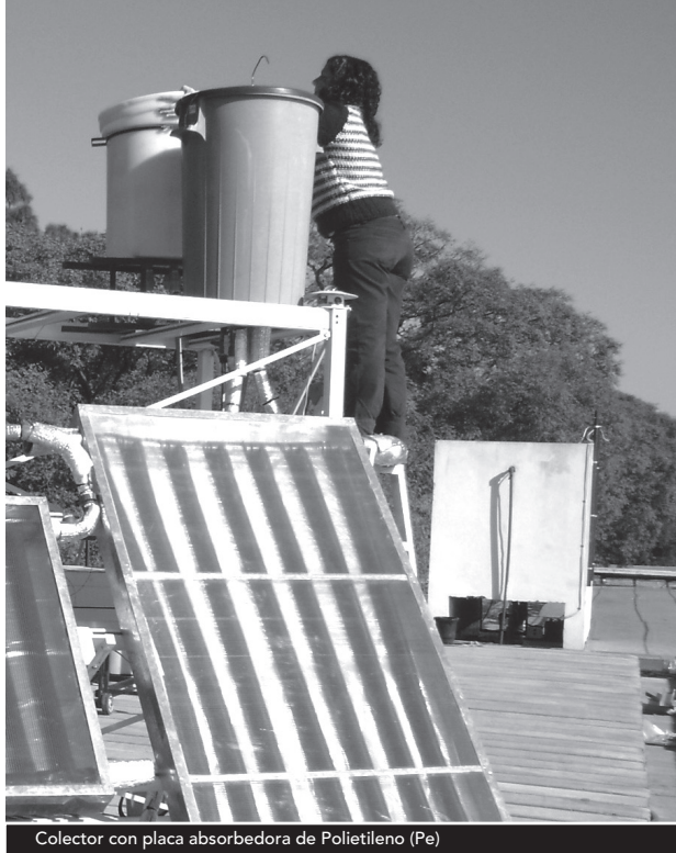
Colector con placa absorbadora de Polietileno (Pe)
