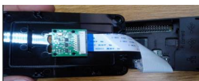
Fig. 2. Módulo de Cámara conectado a la Raspberry Pi 2 Model B
