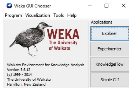
Fig. 2. Ventana principal de WEKA, desde aquí se puede elegir la opción Explorer para trabajar con el set de datos y realizar las pruebas con los algoritmos de clasificación. Desde la opción Experimenter compararemos los algoritmos elegidos para ver en detalle su precisión.
