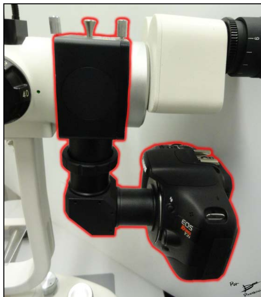
Figura 18. Biomicroscopio equipado con Beam-Splitter adosado a una cámara fotográfica para la captura de imágenes.
