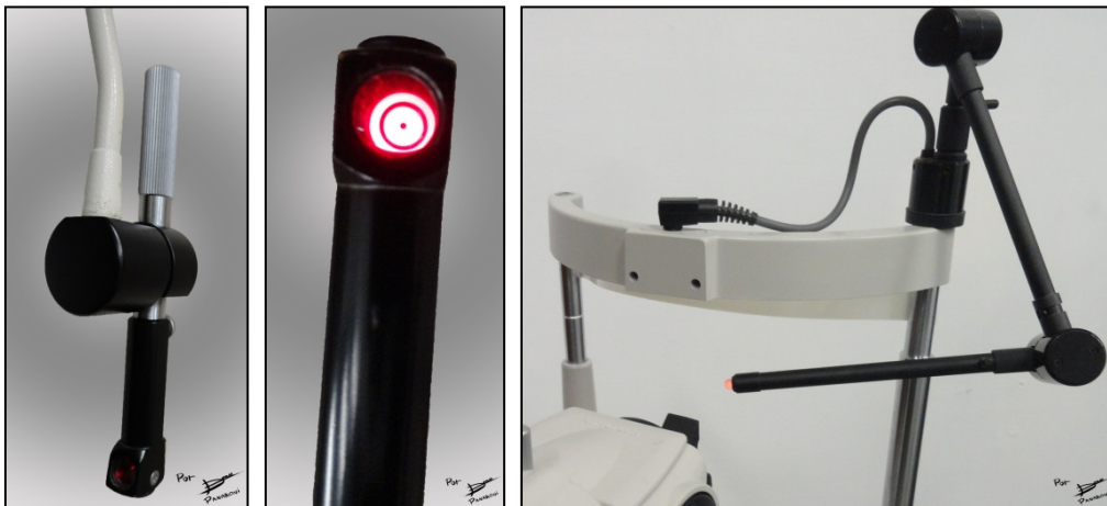
Figura 21. A la izquierda un objeto de fijación de proyección con vista lateral, al medio se observa el testigo del mismo objeto de fijación. A la izquierda otro diseño de objeto de fijación que consiste solamente de un LED.
