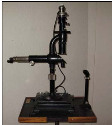
Figura 1: Gran oftalmoscopio de Gullstrand
