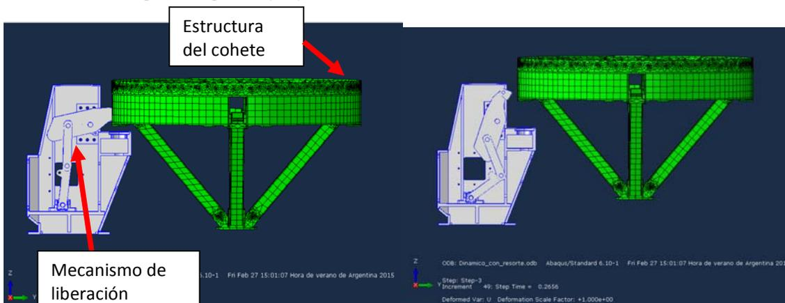
Figura 6. Vista esquemática de uno de los sistemas de liberación para realizar simulaciones
