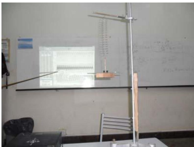
Figura 1: Sistema masa resorte que realiza un movimiento armónico amortiguado.
