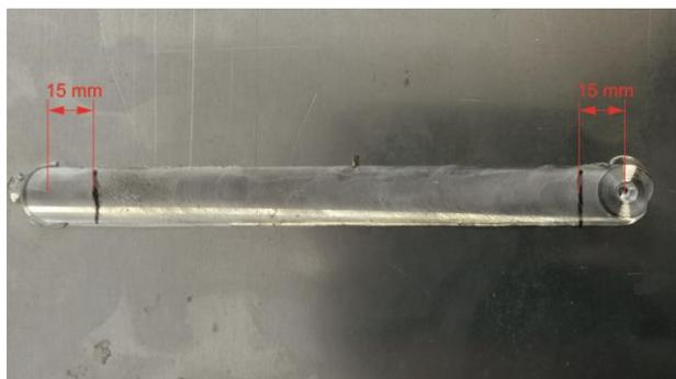
Figura 3: esquema de corte de probetas para el análisis micrográfico.
