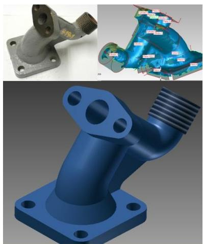
Fig.6. Foto de la pieza, trabajo con la malla, modelo paramétrico
