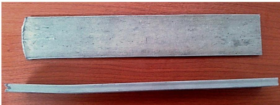
Figura 3: Placas deformadas en caliente
