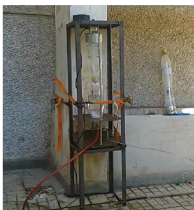
Figura 2: Banco ensayo estático y resultado de un ensayo de empuje tipo
