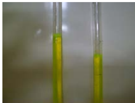
Figura 8. Equipo encendido, se observa el desnivel en las ramas.
