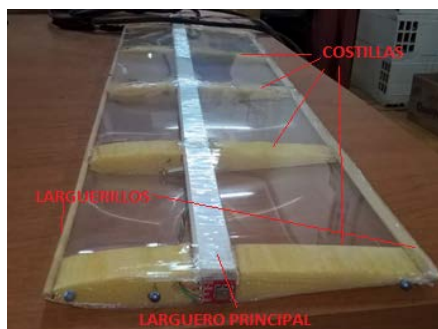
Figura 4. Configuración del ala con el larguero al 40% de la cuerda.
