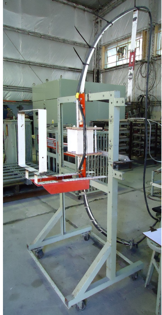
Foto 2 - Instalación de ensayo según norma IRAM 3904/04 [3].
