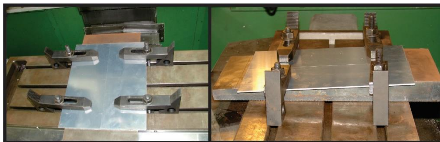
Figura 2: Chapas dispuestas en respaldo para ser soldadas.
