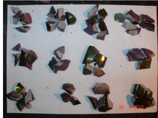
Foto 11. Trozos de porcelana luego del ensayo de porosidad preparados para la observación
