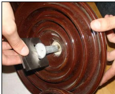
Foto 4. Verificación de la rótula
