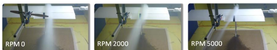
Figura 3: Visualizaciones con humo del flujo sobre el ala en vista posterior a distintas RPM.
