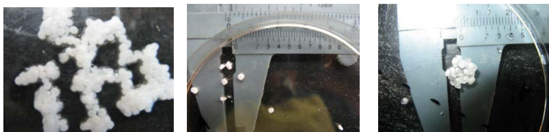
Figura 2 a) Microesferas de QS en TPP, b) Microesferas de QS-TPP liofilizadas, c) Microesferas de QS-TPP liofilizadas y rehidratadas 6 h en agua
