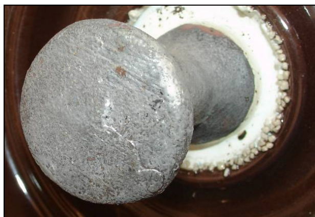
Foto 12. Detalle de un badajo con defectos de la capa de galvanizado.
