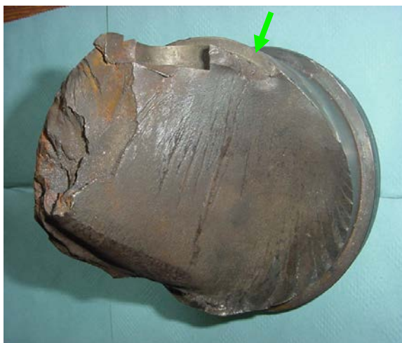
Figura 2. Eje del generador y acople con evidencia de una fractura por fatiga torsional. Craighead, I.A. and Gray, T.G.F. (2004) Investigation of diesel generator shaft and bearing failures.
