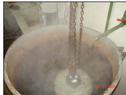
Foto 9. Aisladores en el baño caliente
