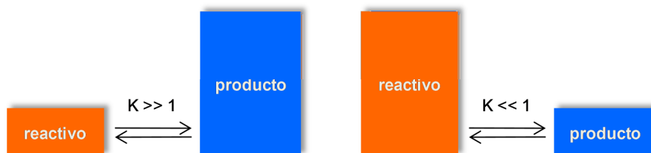
Figura 8.3. Representación esquemática de la concentración de reactivos y productos para una reacción cuya constante de equilibrio es mucho mayor que 1 y mucho menor que 1.
