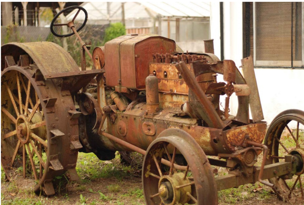
Figura 10.13. Tractor de hierro sujeto a corrosión.
