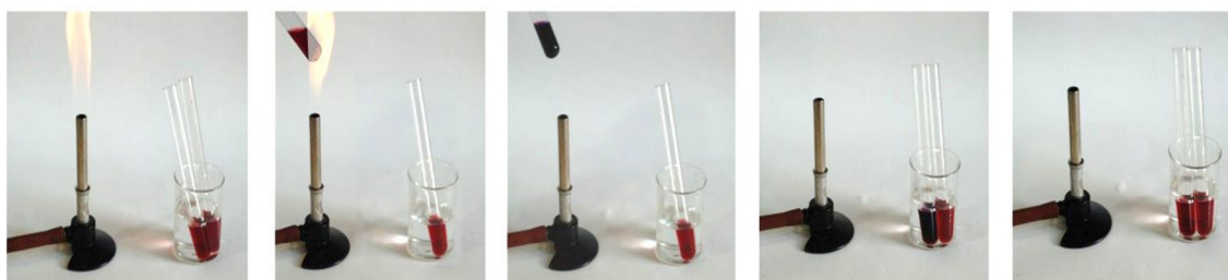
Figura 8.8. Efecto de la temperatura en la reacción de equilibrio químico de una solución acuosa de \text{Co}^{2+} en presencia de cloruro.
