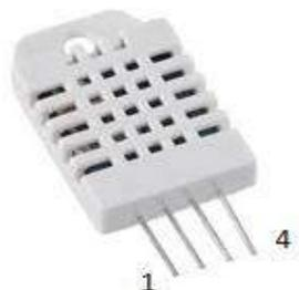
Figura 3. Sensor DHT22.
