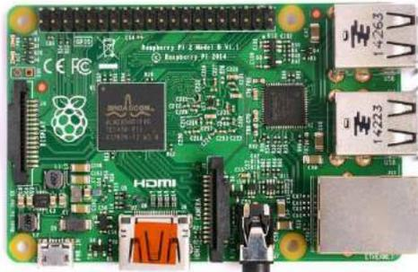
Figura 1. Raspberry Pi 2 modelo B.
