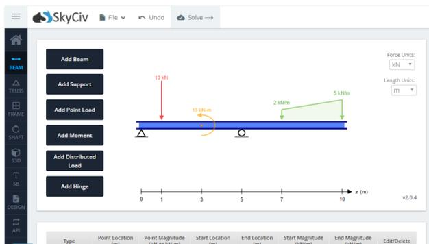
Ilustración de la captura de pantalla del software skyciv en donde se puede apreciar un sistema de una chapa isostática, constituida por un apoyo simple y uno doble y un estado de cargar conformado por una carga puntual, una distribuida y un momento concentrado.
