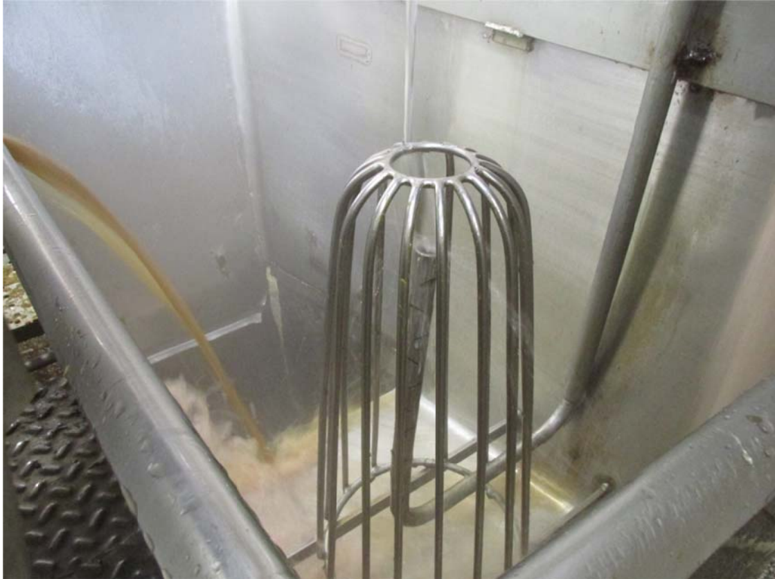
Foto 7. Lavador de mondongos llamado "Paraguas" o "Sombriila". Tira agua desde adentro y desde arriba por una lluvia.
