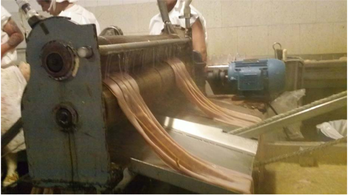
Foto 12. En esta foto se aprecia el desarrado por compresión de las tripas mediante los rodillos, dejando la submucosa.
