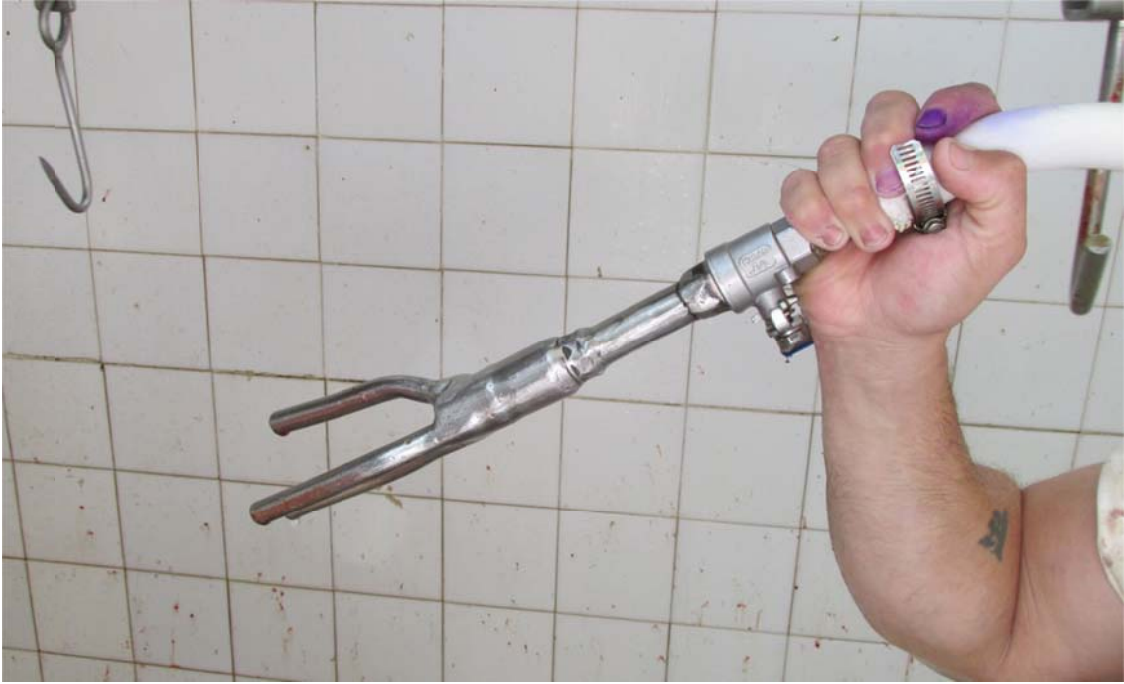
Foto 29. Elemento utilizado para lavado de cabeza con tres salidas de agua (dos para ollares y uno para la boca)
