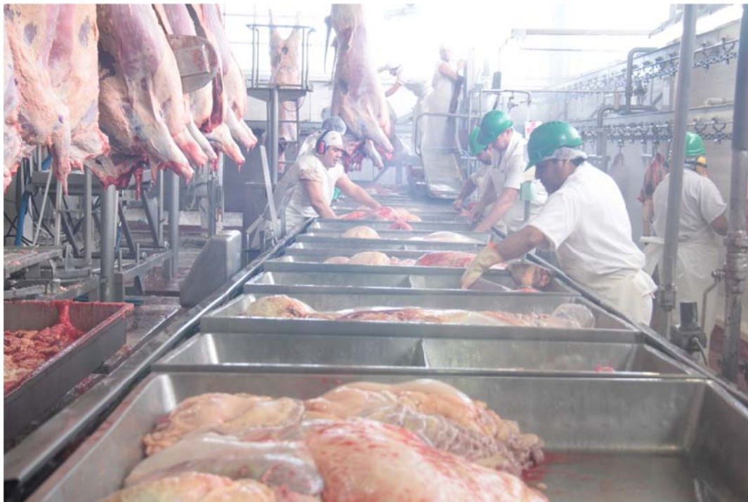
Foto 19. Se observan las tres norias: de reses, de menudencias y de cabezas. En la noria de menudencias se revisa por palpación y cortes el hígado, pulmón, corazón, tripales (intestinos) y bazo.
