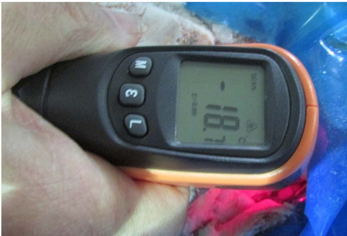
Foto 23. Determinación de la temperatura de un producto congelado mediante un termómetro con sistema infrarrojo. Nótese que en las fotos 21, 22 y 23 el producto no está envasado al vacío.
