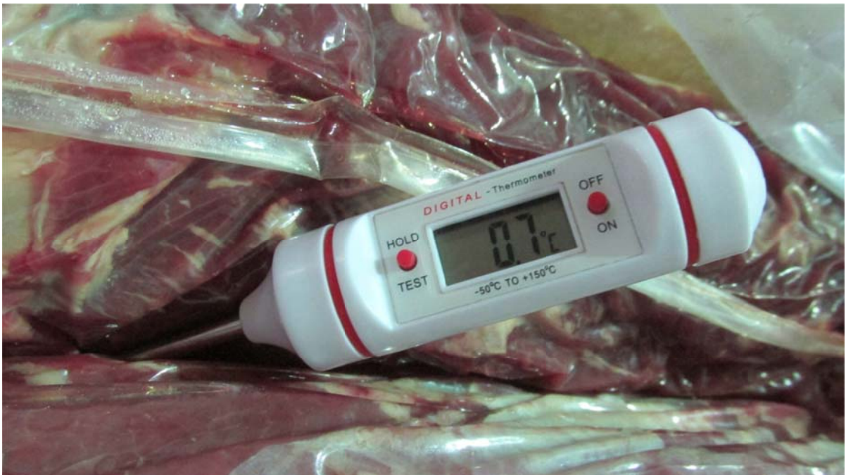
Foto 27. Determinación de la temperatura en cortes enfriados: se realiza con termómetros digitales.
