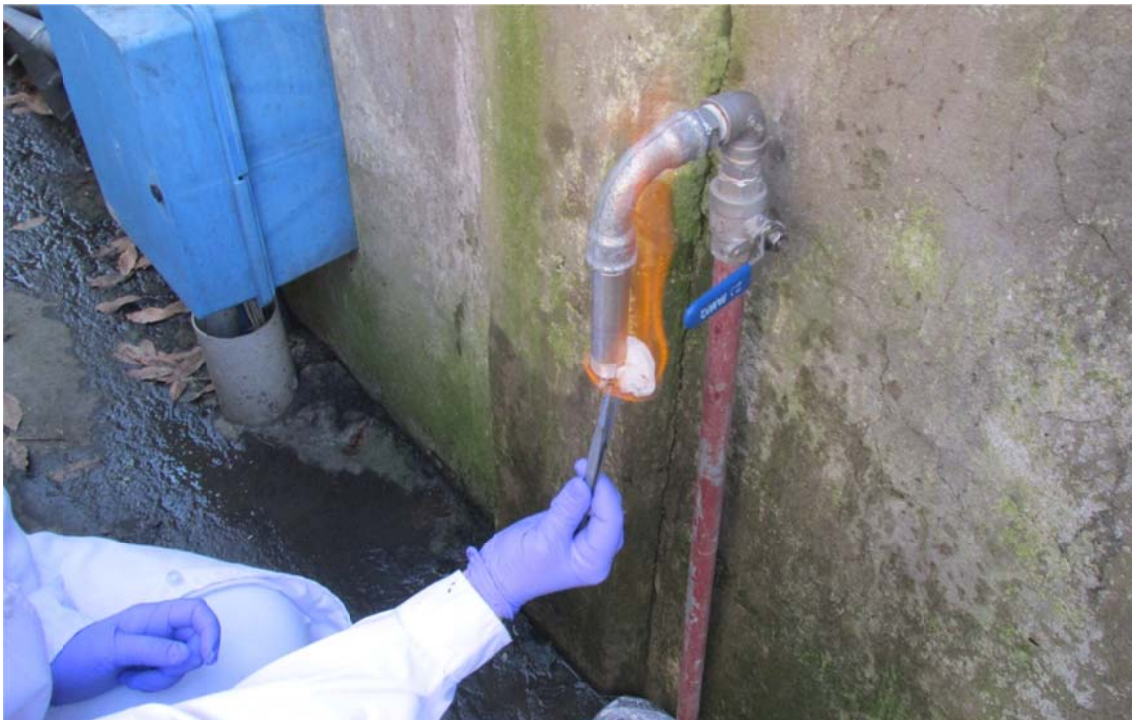
Foto 31. Flameado de la canilla con fuego. Luego de esta operación se debe abrir la canilla y dejar correr el agua durante 1 minuto.
