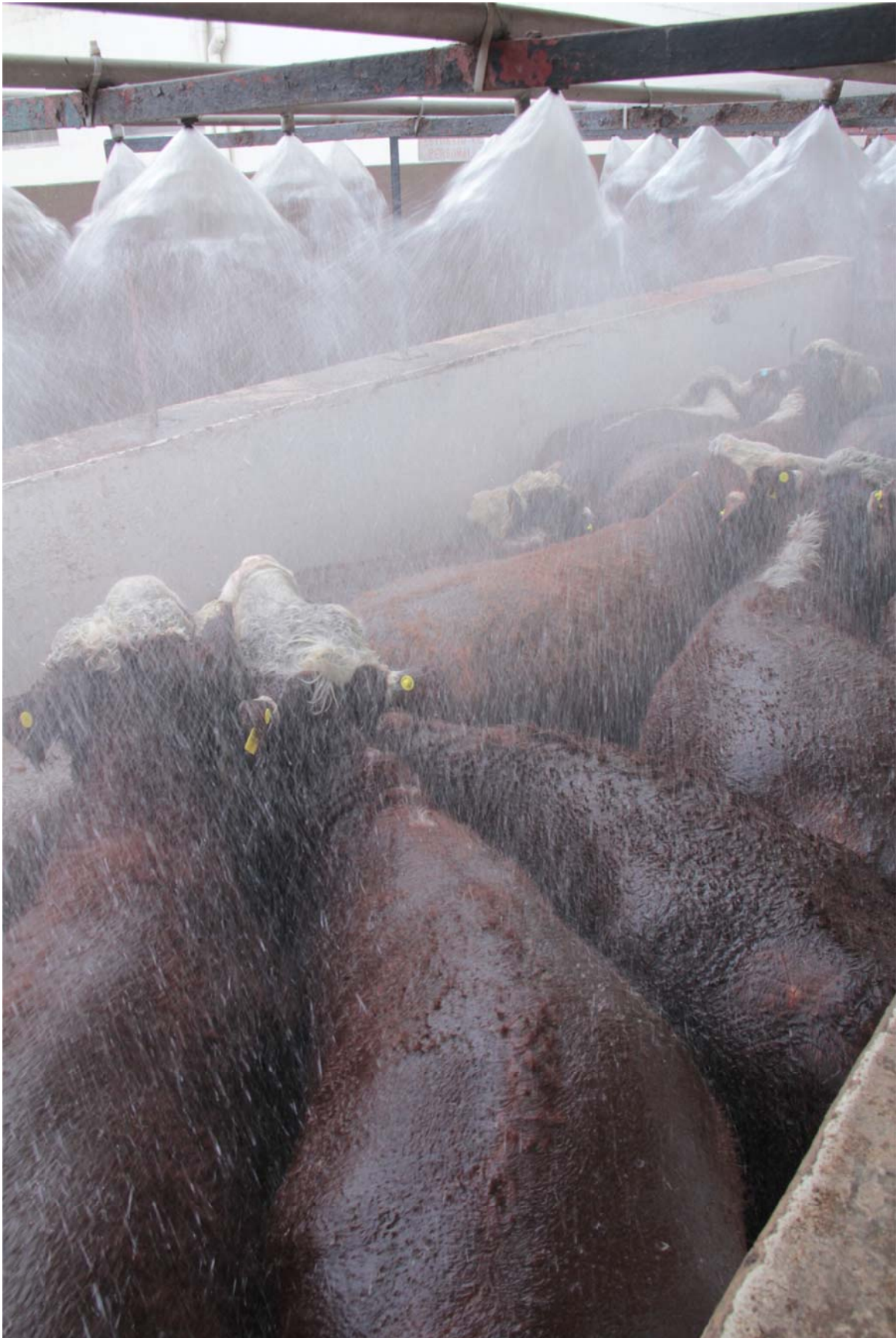
Foto 50. Baño con abundante agua clorinada, para producir disminución de la carga bacteriana y una vasoconstricción periférica para facilitar el desangrado. La presión mínima debe ser de 2 atmósferas y se calculan 300 litros por animal.
