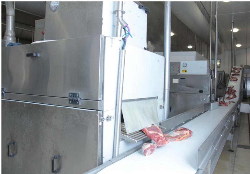
Foto 18. Cortes saliendo de la campana de termocontracción.
