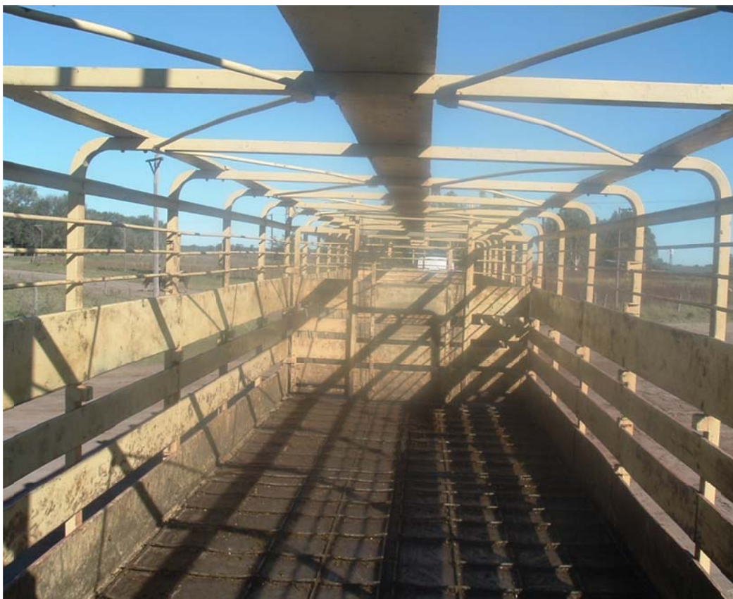
Foto 6. Camión jaula para transporte de bovinos. Obsérvese en el piso los hierros para evitar la caída de los animales. Piso antirresbaladizo.
