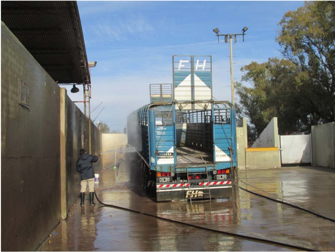
Foto 36. Lavado del camión con agua a presión, la cual a la salida del pico debe ser, como mínimo, de 1 atmósfera. El lavado debe realizarse tanto adentro, como afuera del transporte.
